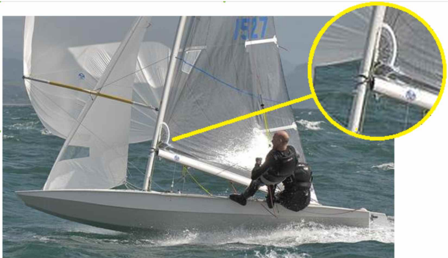
Fig. 3: Mit den Laminat-Grosssegeln hat der Cunningham-Strecker an Bedeutung gewonnen.
