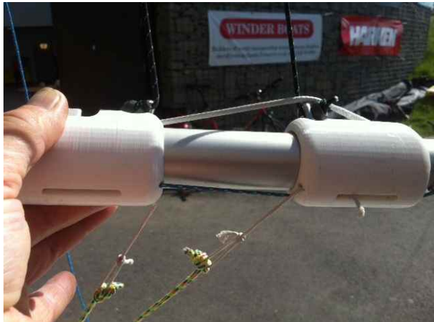
Fig. 6: das Spibaum-System nach Sayce/Rees verbindet die Vorteile von Single-End und zweiendigen Spibaumen
